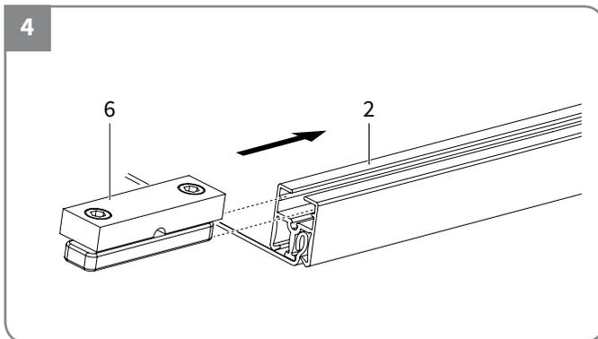
Schieben Sie das Seilbefestigungsklötzchen (6) in die vordere Schiene und positionieren Sie es ebenfalls genau in der Mitte.
