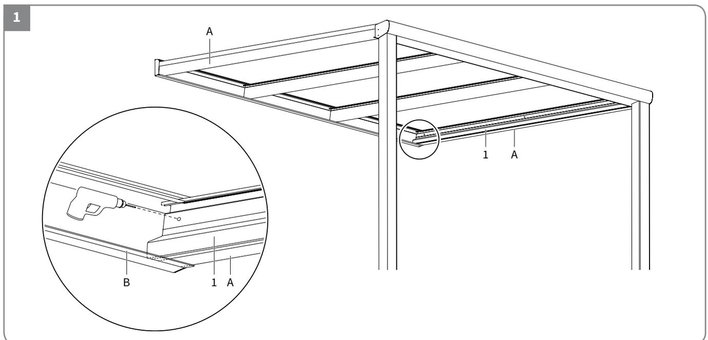
Bei diesem 3 m breiten Sonnenschutz sind die Seitenführungen (1) an den äußeren Trägern (A) der Terrassenüberdachung angeordnet.
