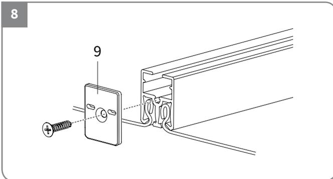
Versehen Sie die Schienen an beiden Enden mit einer Abdeckplatte (9).
