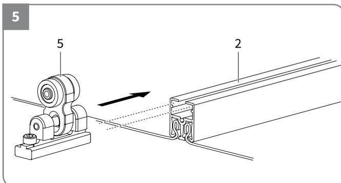
Schieben Sie die Laufräder (5) in die Schienen (2). Dies auf beiden Seiten durchführen. Beachten Sie die Positionierung der Inbusschraube.
