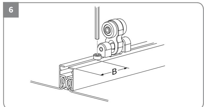
Ziehen Sie das Laufrad mit einem Inbusschlüssel fest. M (B) hängt von der Lage der Seitenführungen ab. Bei der 3 m-Ausführung ist dieses Maß 50 mm.
