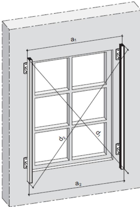
Nach Montage der Führungsschienen auf Parallelität prüfen !
