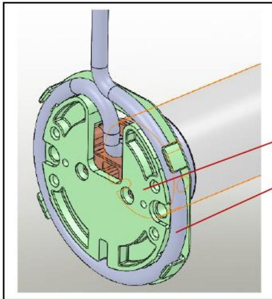
Motorlager mit Kabelreserve und Steckmontage
