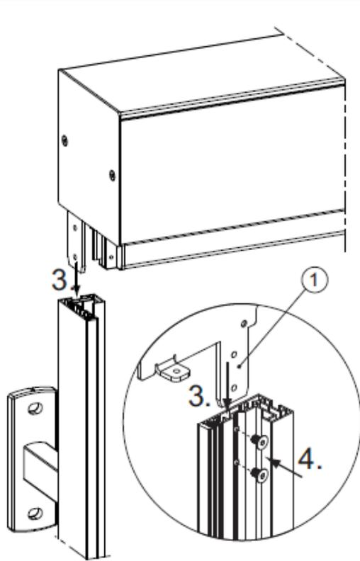
3. Kasten auf Führungsschienen aufsetzen und bis zum Anschlag senken.
