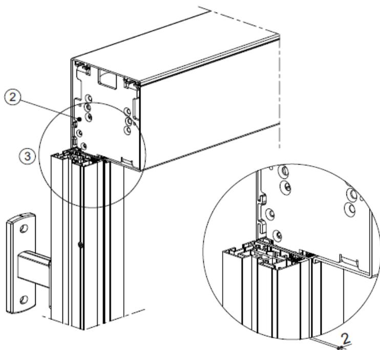
Bei der Reihenmontage ist für die Mittelsituation kein Abdeckblech vorhanden. Der Abstand zwischen den Führungsschienen und den Kastenprofilen muss 2 mm betragen.
